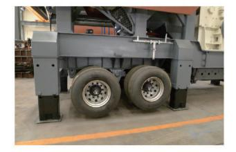
采用液压支腿 (选装),便于现场安装;料仓 采用组合设计,大大降低运输高度。
