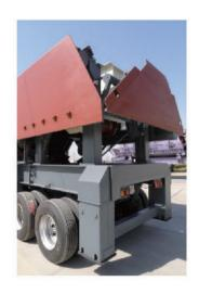
移动底盘设计符合国际标准,拥有符合规范 的灯光和制动系统。底盘采用大截面型钢,为重载 设计。
