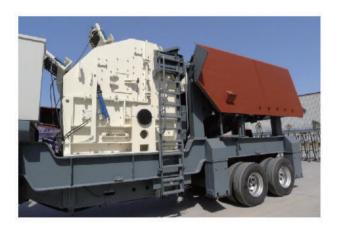
移动底盘采用 U 型梁设计,降低了移动站的整体高度,大大降低了破碎物料的装运成本。
